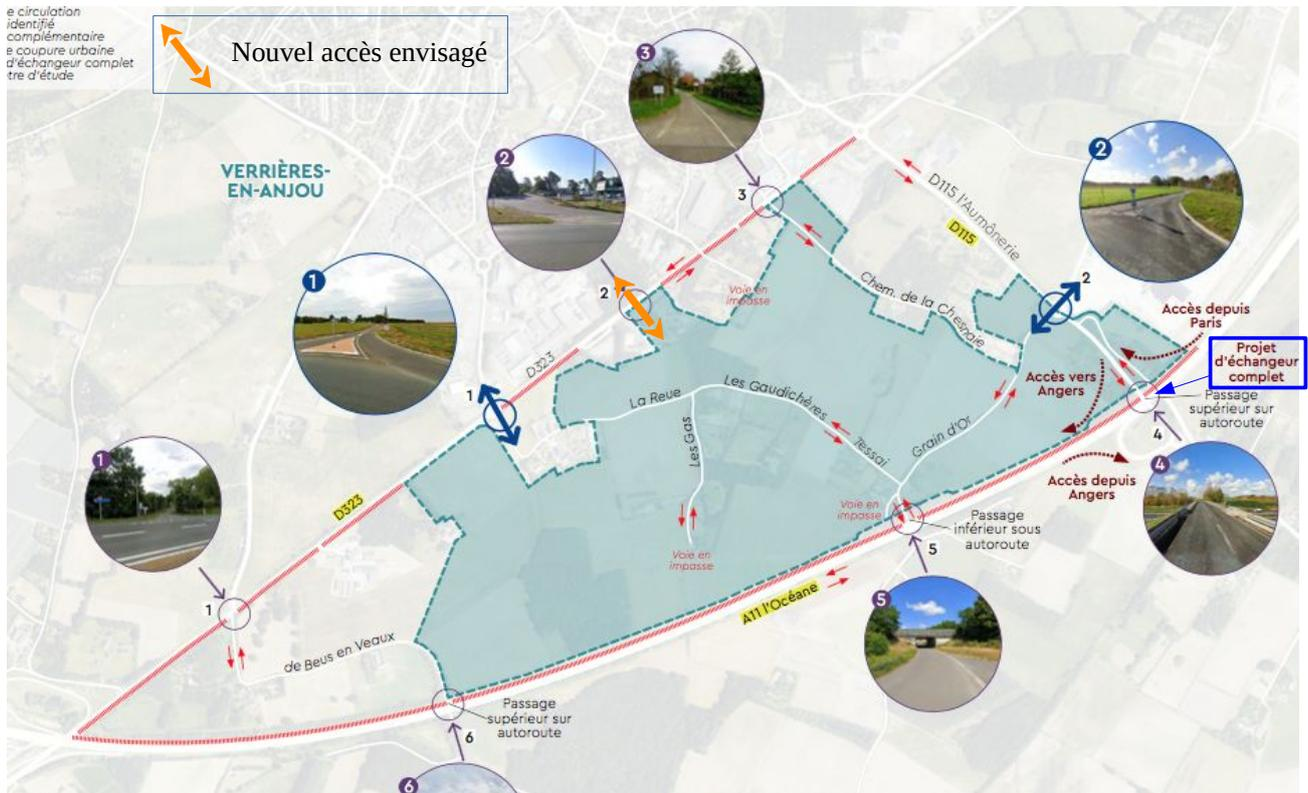
L'ajout d'un nouveau parc d'activités risque de conduire à la saturation de l'échangeur existant du Plessis Grammoire (cadre bleu). Pour l'éviter, il est envisagé des reconfigurations et notamment la construction d'un échangeur complet.
